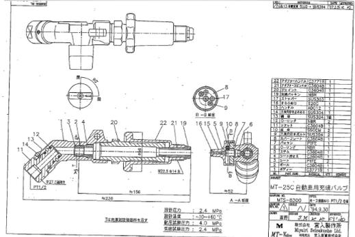
126 MT25C型 充填ガンノズル
